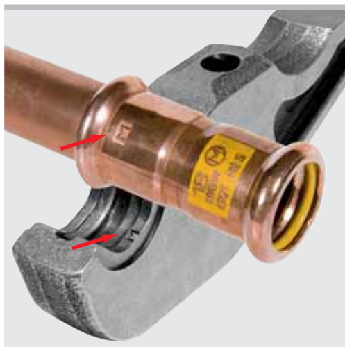
Przykład REMS cęgi zaciskowe M: Odcisk „M” na zaciśniętej ączce dla umożliwienia kontroli wstecznej zgodnie EN 1775:2007
