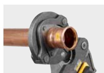
Pierścienie zaciskowe REMS (PR) z 3 poprowadzonymi na przegubowym pierścieniu segmentami zaciskowymi do wymagającego zaciskania dużych rozmiarów. Optymalne zaciskanie poprzez promieniowo sterowany ruch segmentów zaciskowych, z cęgą pośrednią.
