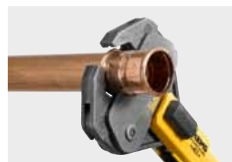
Cęga zaciskowa REMS (4G) z 2 przegubowymi, równoległymi biegnącymi segmentami zaciskowymi do prostoliniowego zaciskania średnich rozmiarów.
