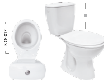
WC Kompakt PRESIDENT P 020 Odpływ pionowy, doprowadzenie wody z boku (P 010) lub od dołu (P 011). Rozmiar: 35x67 cm
