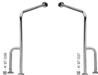
Uchwyt ścienna-podłogowy, lewy/prawy Długość: 75 cm; Wysokość: 80 cm Maksymalne obciążenie: 120 kg
